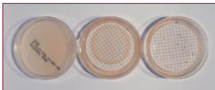
A Placa virgen B Agua Potable (10 ml) Incubación a 22°C/ 48 horas <100 ufc/ml C Agua Potable (10 ml) Incubación a 37°C/ 48 horas <10 ufc/ml
