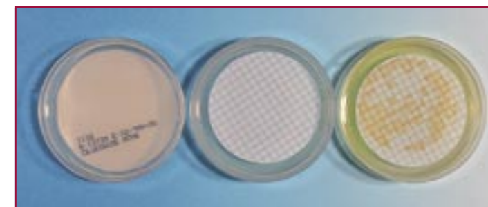
A Placa virgen B Agua envasada (250 ml) Incubación a 37°C/ 24horas Ausencia/250 ml C Agua Contaminada con P. aeruginosa ATCC 10145 (100 ml) Incubación a 37°C/ 24horas Presencia
