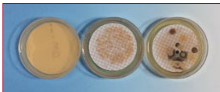
A Placa virgen B Agua contaminada con C. perfringens ATCC 13124 (100 ml) Incubación anaeróbica a 37°C/ 24 horas Presencia C Agua contaminada con C. perfringens ATCC 13124 (100 ml) Incubación anaeróbica a 37°C/ 72 horas Presencia
