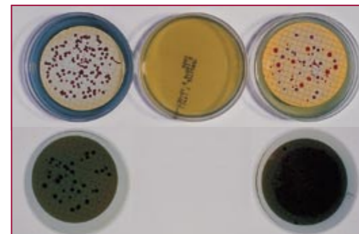
A Agua contaminada con S. typhimurium ATCC 14028 y P. aeruginosa ATCC 10145 (100 ml) Incubación a 37°C/ 24horas Ausencia de coliformes B Placa virgen C Agua contaminada con S. typhimurium ATCC 14028 y E. coli ATCC 25922 (100 ml) Incubación a 37°C/ 24horas Presencia Placa A invertida No aparece halo amarillo Placa C invertida Aparece halo amarillo
